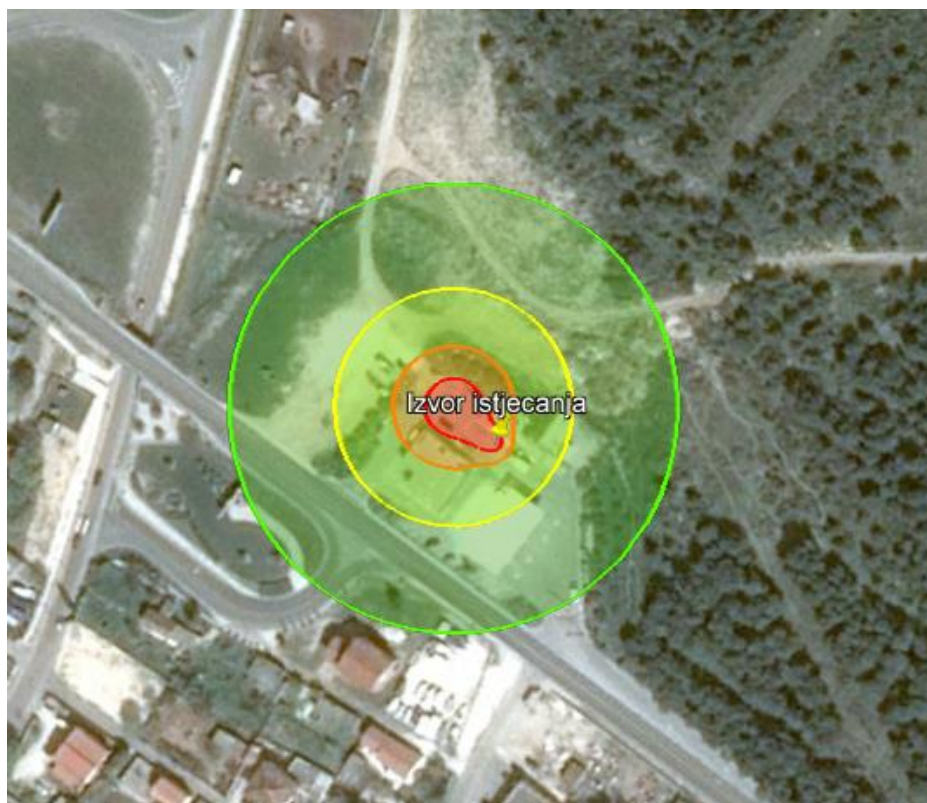
Slika 4. Zone ugroženosti uslijed eksplozije plinske faze
