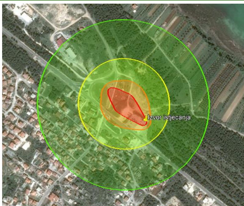
Slika 19. Zone ugroženosti uslijed eksplozije cjelokupne količine UNP-a
