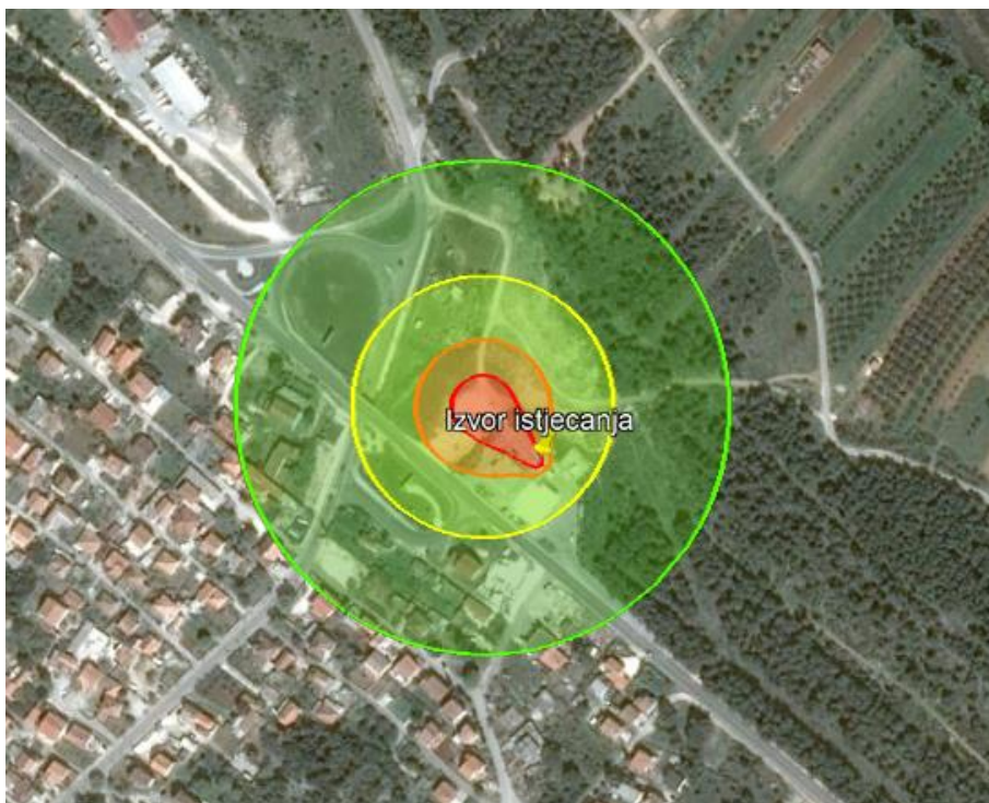
Slika 2. Zone ugroženosti uslijed eksplozije plinske faze benzina
