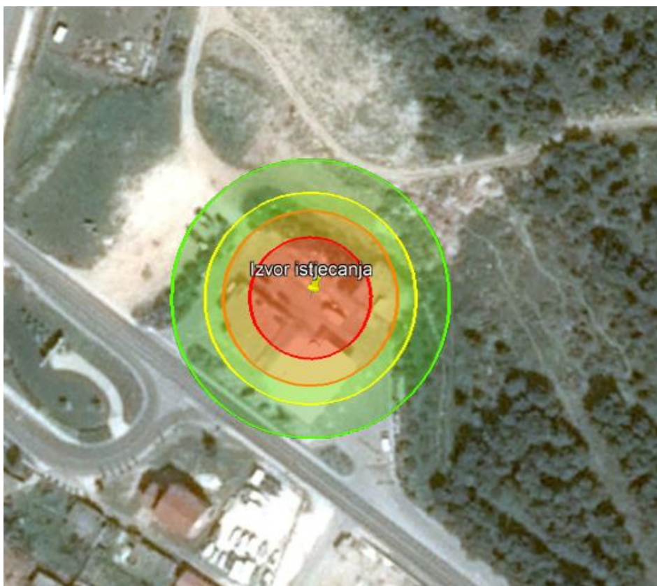
Slika 5. Zone ugroženosti uslijed istjecanja manje količine benzina i nastanka požara
