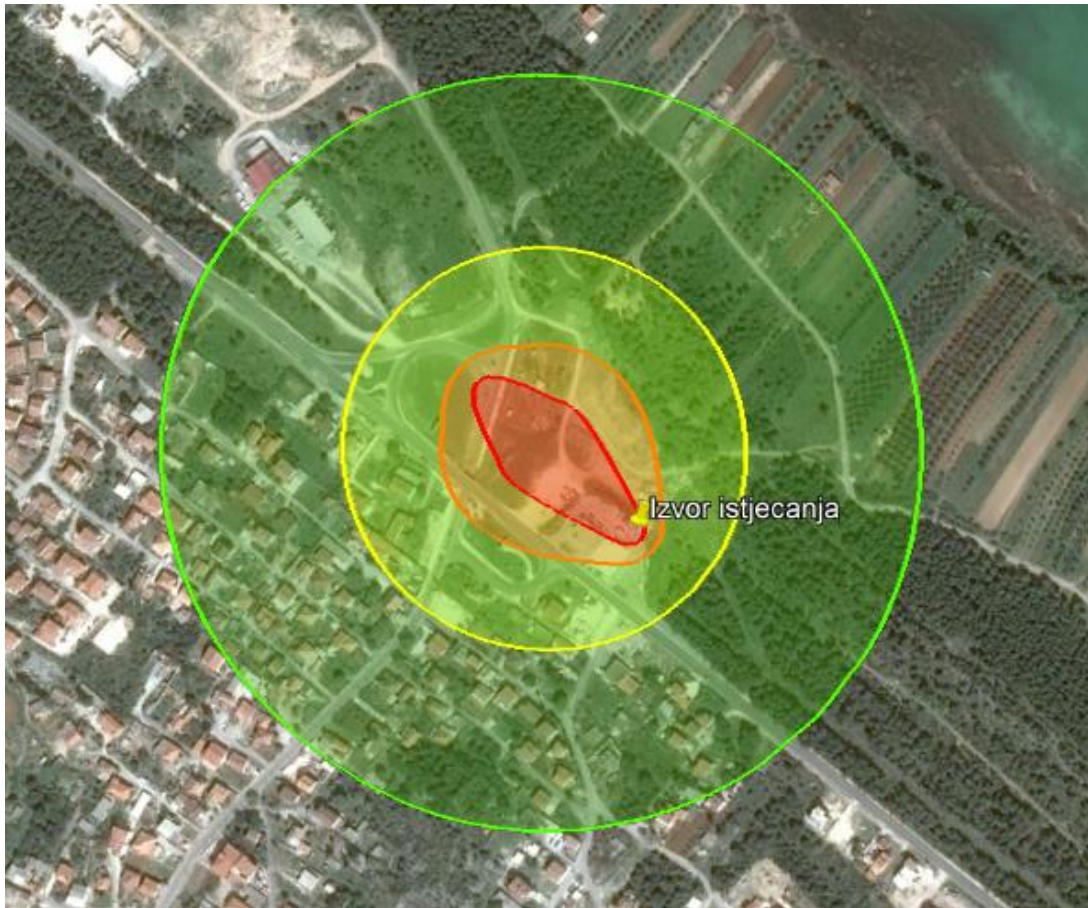
Slika 8. Zone ugroženosti uslijed eksplozije cjelokupne količine UNP-a
